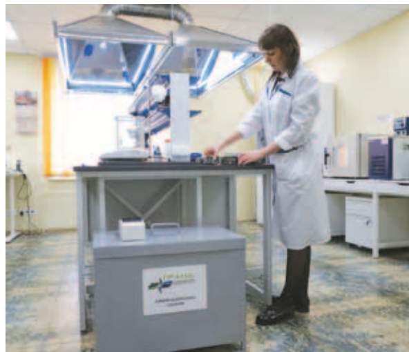
Камера ускоренного старения – собственная разработка лаборатории «ГРАНД»
