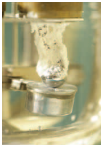
Метод «кольца и шара» («Килл») используется для проверки температуры размягчения термопластика.
