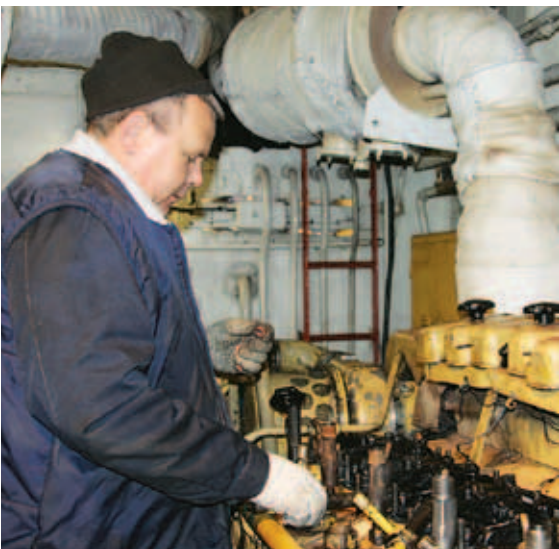
Валерий Шуталев, второй механик (сборка вспомогательного двигателя)
