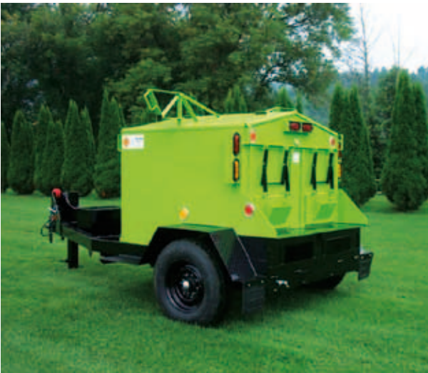
Прицепной рециклер емкостью 2 куб. м фирмы Ray-Tech Infrared Corp
