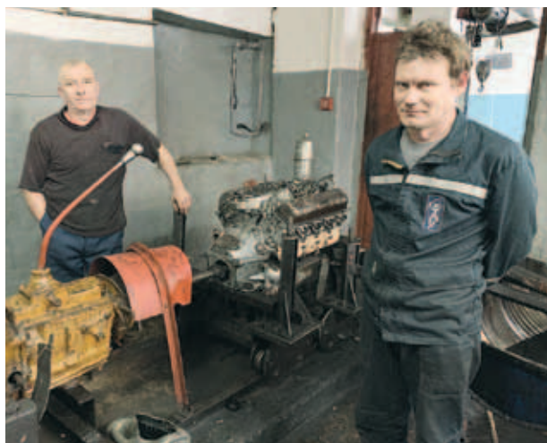
Валерий Черников и Анатолий Логутов, мотористы, производят обкатку автобусного двигателя
